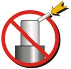
Keine Seitenkräfte. Der Arbeitshub muss senkrecht zur Grundfläche der gasdruckfedern verlaufen. Aufgrund ihrer nicht standardisierten Konstruktion sind CRAL-Gasdruckfedern besonders anfällig für die nachteiligen Auswirkungen von Seitenkräften. Es ist sehr wichtig, richtig dimensionierte (möglicherweise überdimensionierte) und effiziente Führungselemente im Werkzeug zu verwenden, um einen senkrechten Arbeitshub zur Basis zu gewährleisten.
